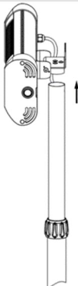
Étape 4: Vissez la poignée à travers le capuchon du tube supérieur dans le tube supérieur.
