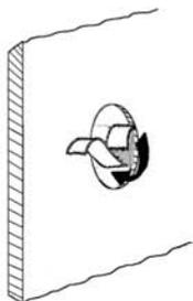
Enrouler un ruban d'étanchéité en PTFE sur les filets du tuyau. Il peut s'avérer nécessaire pour l'installation d'y joindre un mamelon de raccord (non inclus).
