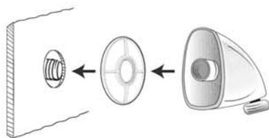
Sécuriser le joint autour du tuyau afin de permettre une bonne étanchéité entre la fixation murale et le mur de la douche. Joindre le filetage à l'arrière du coude d'alimentation à celui du tuyau et serrer manuellement en position.
