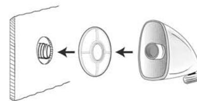
Coloque la junta alrededor del caño para lograr un buen sellado entre el codo de suministro y la pared de la regadera. Una la rosca de la parte posterior del codo de suministro con la rosca del caño y gire manualmente hasta ajustar bien.
